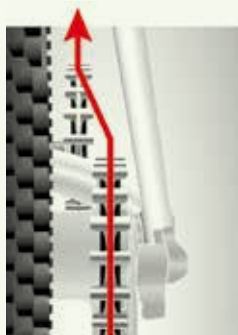
Bild 46. Dreven är inte korrekt inriktade för @Gates
