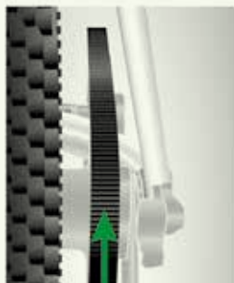
Fig. 45. Alignement correct de la courroie @Gates
